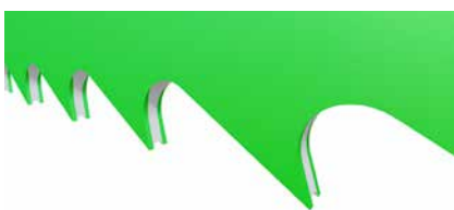
Meerdere zaagranden / gespleten spanen
