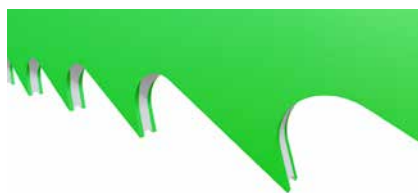
Meerdere zaagranden / gespleten spanen
